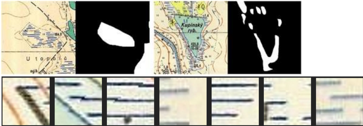
Obr. 3. Příklady trénovacích dat pro neuronovou síť U-Net (horní řádek), a SSD (dolní řádek). Převzato z Vynikal et al. (2024)
